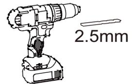
Para facilitar a fixação dos parafusos, faça um pré-furo com uma broca de 2,5mm
