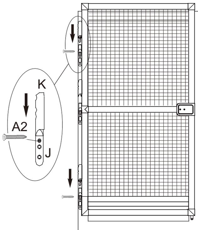
Encaixe o conjunto da porta na parte inferior da dobradiça que já está fixada na parede e aperte os parafusos, observe que o parafuso fixa também a parte inferior da mola.
