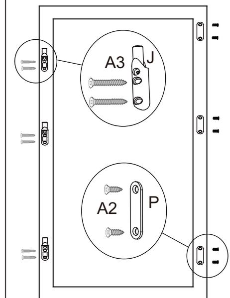
Retire os adesivos e fixe as chapeletas e a parte inferior da dobradiça na parede
